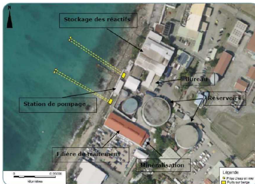
Photo n° 1 : vue aérienne de l'usine de dessalement
